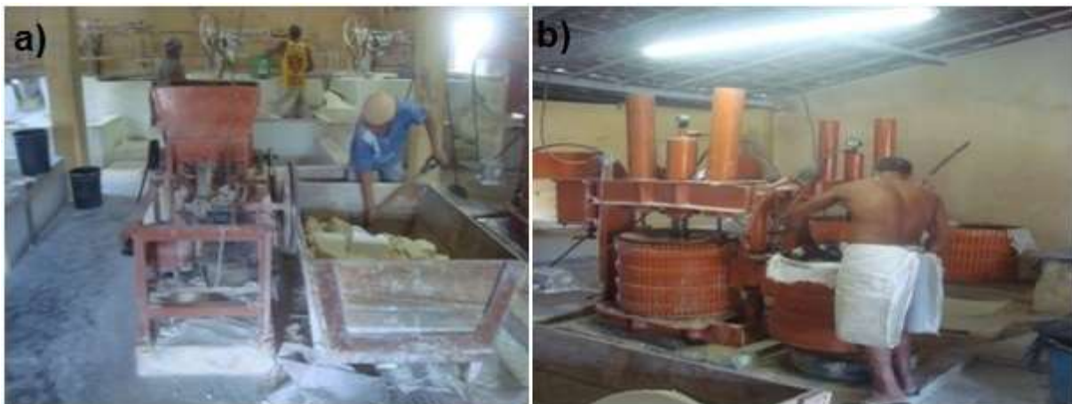
Figura 6 A - Trabalhador alimentando triturador com mandioca em casa de farinha nº. 11 - Olho D' Água dos Pombos- Lajedo; Figura 6 B - Prensa hidráulica em operação em casa de farinha nº. 11 - Olho D' Água dos Pombos- Lajedo.
