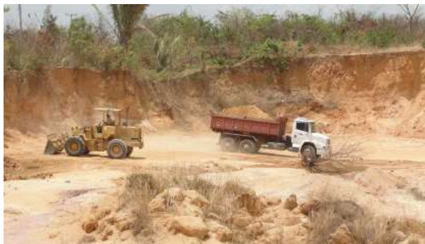
Figura 1 – Fotografia mostrando os métodos de extração de massará, usando pás carregadeiras no Bairro Monte Verde, na Zona Norte de Teresina-PI
