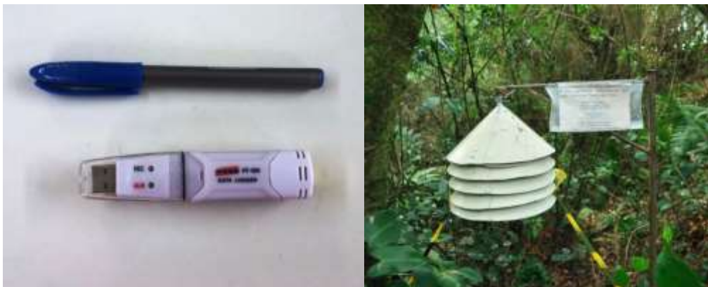
Figura 3: Sensor digital (datalogger) e abrigo meteorológico instalado no ponto P8.
