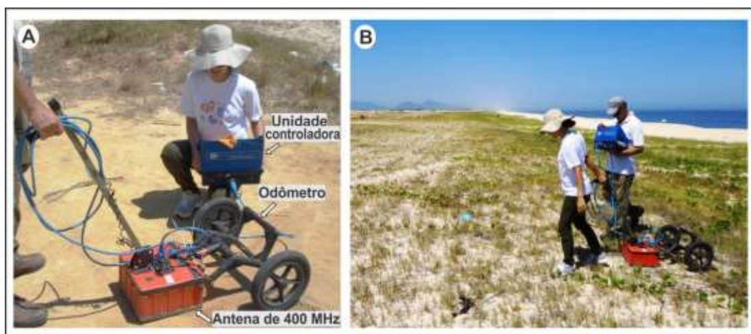
Figura 3 – (A) Georadar GSSI, modelo SIR-3000. (B) Aquisição dos perfis de georadar perpendiculares à planície costeira de Maricá.
