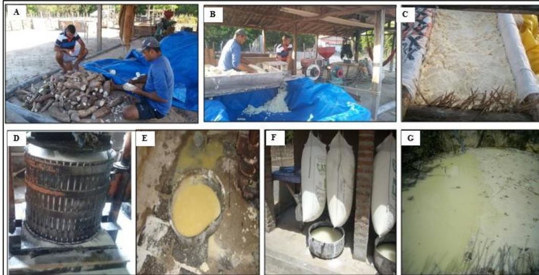
A: Descascamento; B: Moagem; C: Massa; D: Prensagem; E: Resíduo; F: Decantação da massa; G: Manipueira disposta no local.
