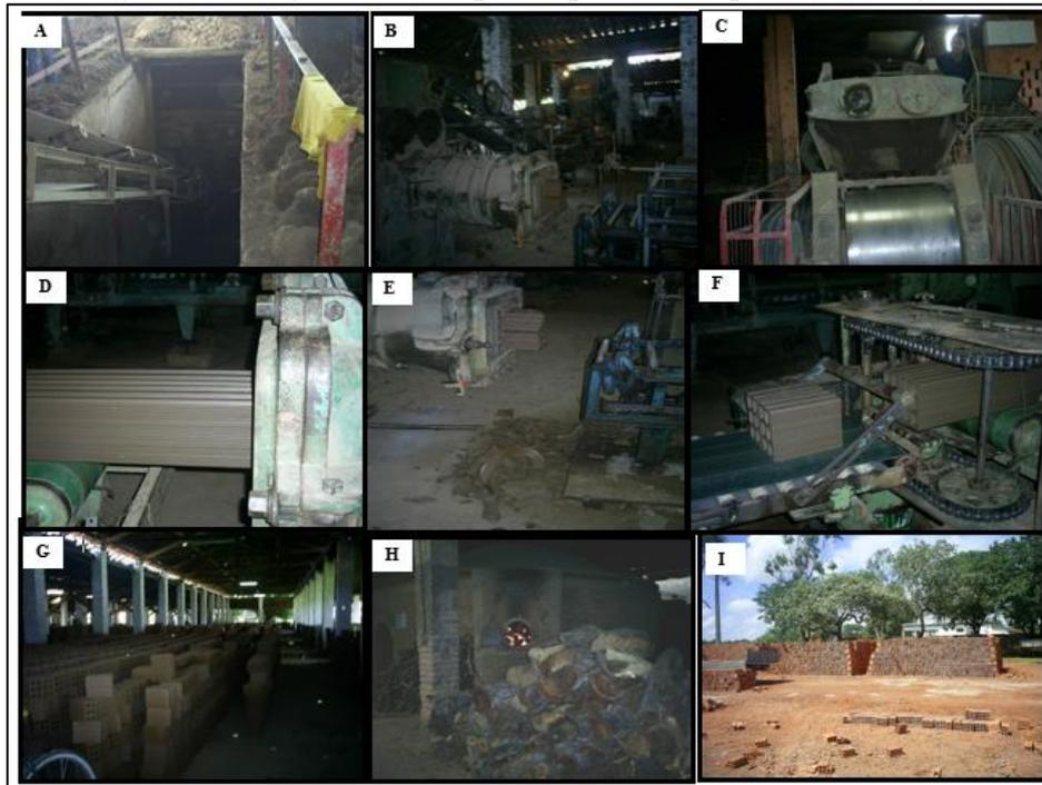
A: Caixa alimentador; B: Desintegrador; C: Misturador; D: Moldagem; E: Resíduos; F: Cortadeira; G: Secagem; H: Queima; I: Expedição.
