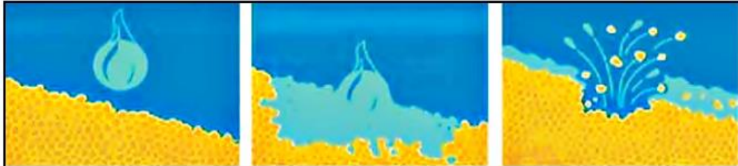
Figura 10 - Esquema da desagregação do solo pelo impacto da gota de chuva Fonte: RITTER, 2006
